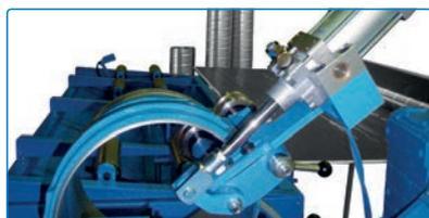
**PLC压筋装置**
