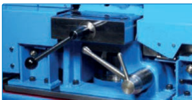
快锁系统 选配快速更换成型模具
