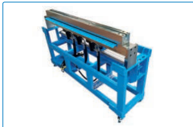
Système de poinçonnage automa- tique pour tirant
